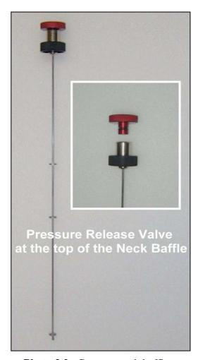
Photo 3.2. Cryostat neck baffle
