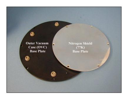
**Photo 1.3.** Cryostat base-plates
