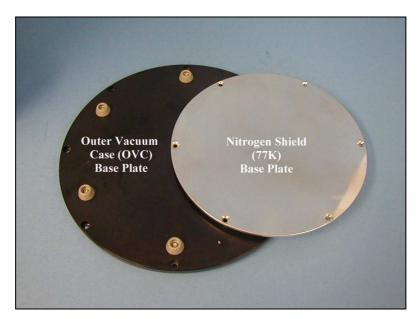
**Photo 1.3.** Cryostat base-plates
