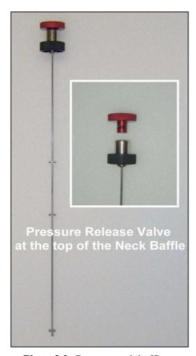
Photo 3.2. Cryostat neck baffle
